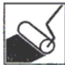
*Pennello e Rullo:* Diluire al 10-15% con SILPRIMER sia per la prima che per la seconda mano. Aspettare 24 ore tra una applicazione e la successiva.
